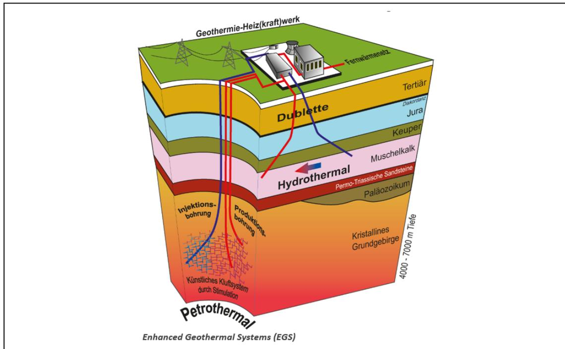
Abbildung 2 – Unterscheidung der zwei grundlegenden tiefegeothermischen Verfahren
